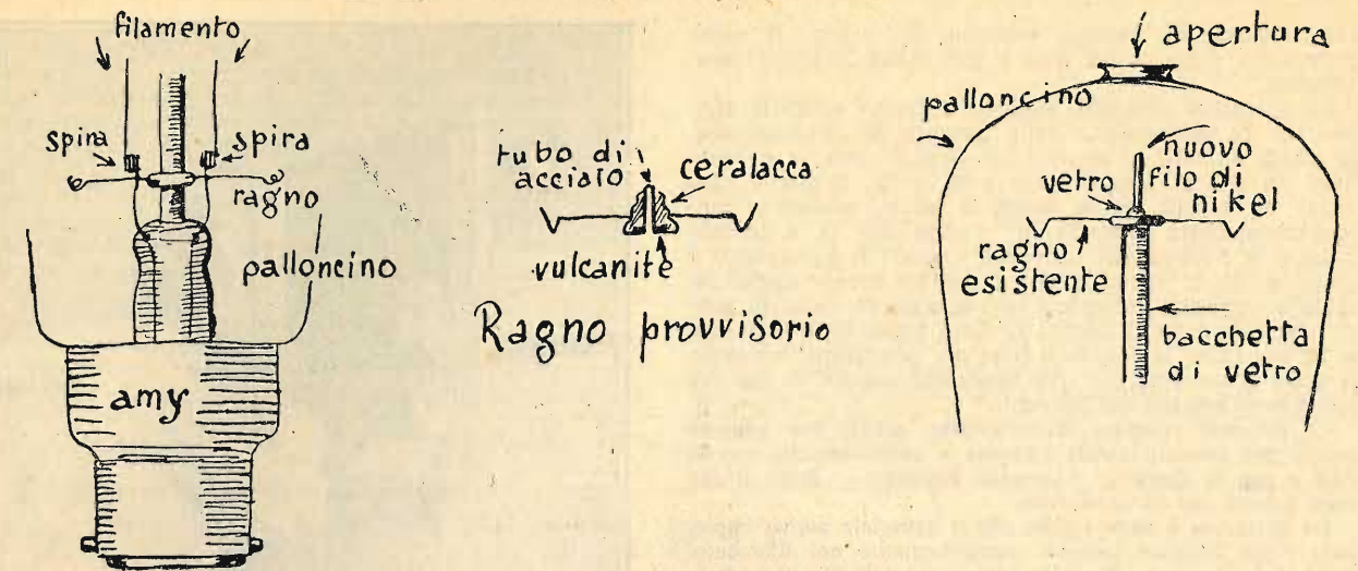
Fig. 1. — Schema di riparazione e rigenerazione di una lampada a filamento metallico.
